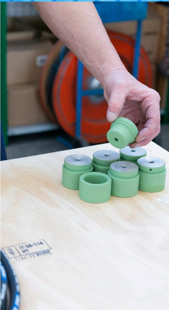
Los **soldadores manuales de polifusión PF** son la solución óptima a las necesidades de soldadura por polifusión (socket) de tuberías y accesorios de PP, PPR, PE y PVDF, tanto para aplicaciones térmicas como industriales.
