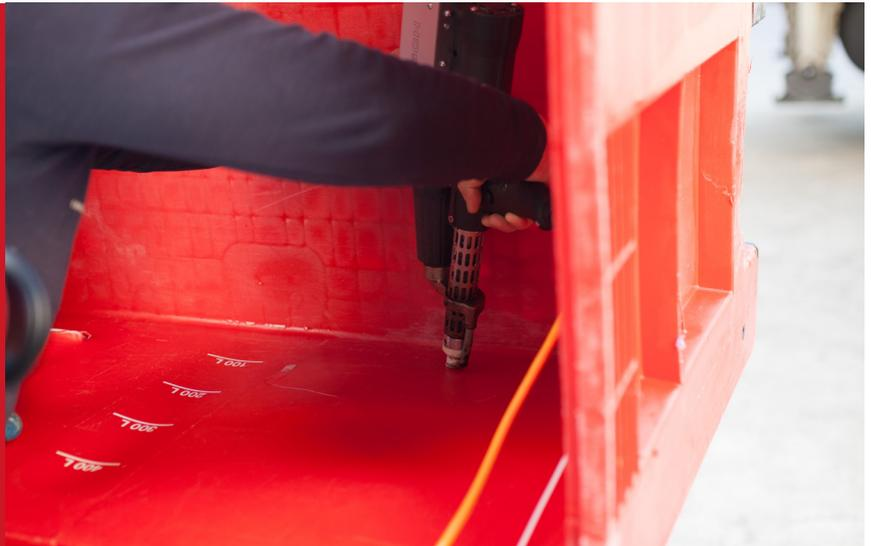
La máquina que más se utiliza para este tipo de trabajos es el modelo MINI, una máquina muy completa de 3,4 kilogramos que se puede usar con una sola mano. Con ella pueden soldarse PP, PE y PVC, entre otros. Es electrónica y, solo seleccionando el material, la máquina de manera automática regula la temperatura adecuada del aire y de la masa. Tiene además velocidad del motor regulable, lo que permite trabajar con el caudal de aire que mejor se ajuste a las necesidades.
