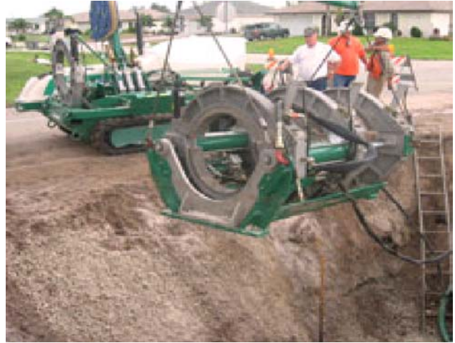
TRACSTAR 900 , desmontando el carro.
