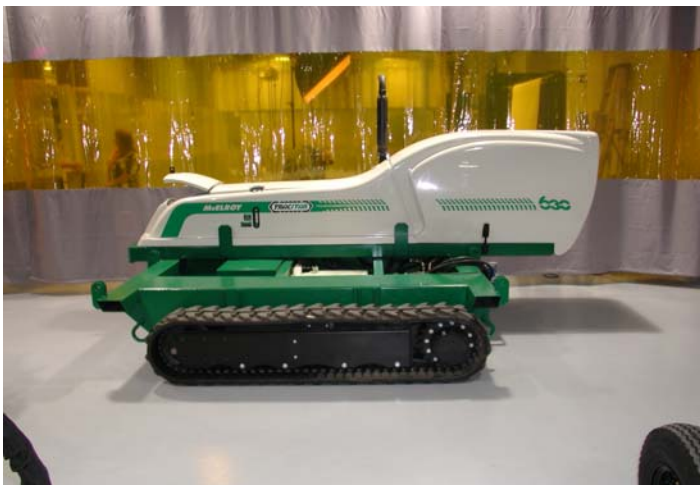
Cuerpo autopropulsado. Sobre él se montan los carros de soldadura.
