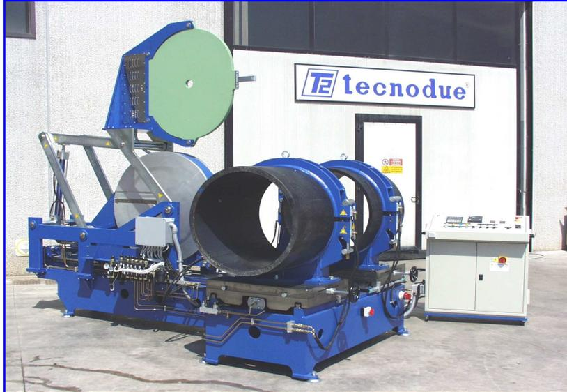
**Máquina para la fabricación de codos hasta diámetro 800mm.**
