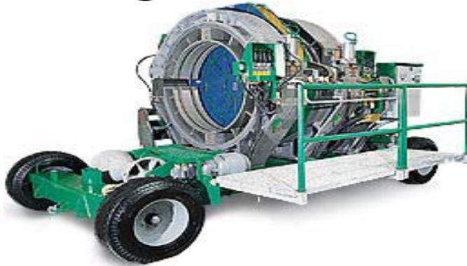
**Máquina hidráulica para soldadura a tope desde diámetro 500 hasta 1600**
