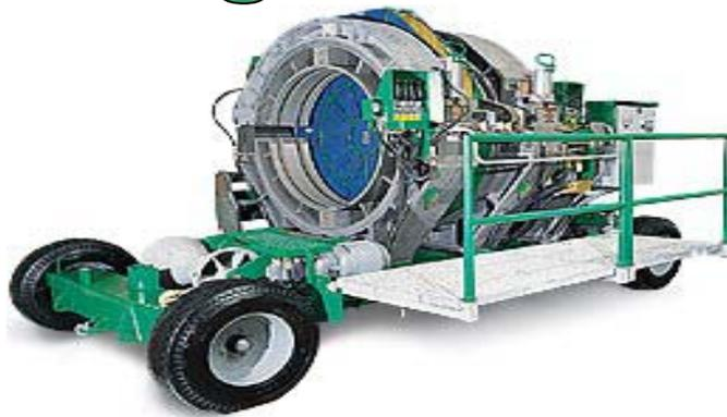
**Máquina hidráulica para soldadura a tope desde diámetro 450 hasta 1200**
